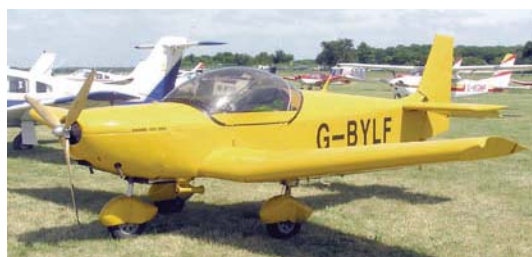
Le CH 601 a été décliné sous de nombreuses versions : HD (capable de résister à +/- 6G, ci-dessus), HDS (voilure trapézoïdale et 225 km/h avec seulement 80 ch, ci-dessous), etc.
