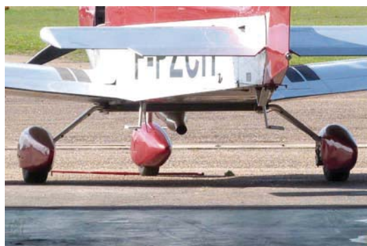
Le train d'atterrissage est tricycle, le train principal à lames métalliques flexibles
