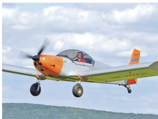
Le CH 601 a été décliné sous de nombreuses versions : HD (capable de résister à +/- 6G, ci-dessus), HDS (voilure trapézoïdale et 225 km/h avec seulement 80 ch, ci-dessous), etc.
